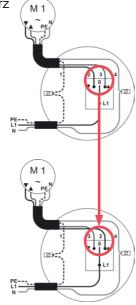
Andernfalls schalten Sie die Spannungsversorgung aus und tauschen die braune und schwarze Anschlussader des Antriebs an den Schaltausgängen des Bedienelements. Die Inbetriebnahme ist nun abgeschlossen.
