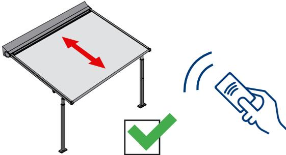
Führen Sie eine vollständige Bewegung der Stützen durch und überprüfen Sie, ob das Produkt korrekt ausund eingefahren wird.
