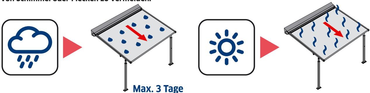
Im Falle einer verstellbaren Stütze: Der Behang darf nicht ein- oder ausgefahren werden wenn die Stütze gesenkt ist. Die Option zum Absenken der Stütze wird nur verwendet, um stehendes Wasser auf dem Behang abzulassen; sobald das Wasser abgelassen wurde, muss die Stütze in die Ausgangsposition angehoben werden.
