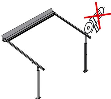
Wenn Sie ein Steuergerät für LEDs-/elektrische Stützen haben mit einem niedrigeren IP-Wert als IP, dann sollte es so angebracht werden, dass es nicht mit Wasser in Kontakt kommt. Zudem sollte es für unauthorisierte Personen unzugänglich sein.
