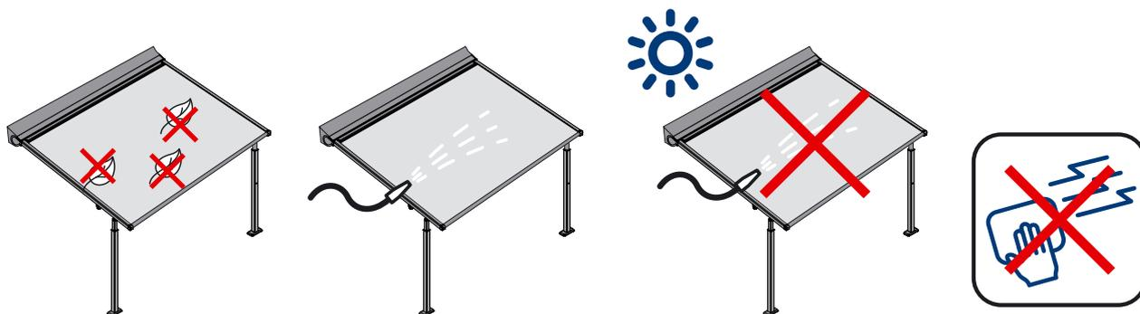
Verschmutzte Metallteile können mit warmem Wasser und einem milden Reinigungsmittel gereinigt werden.
